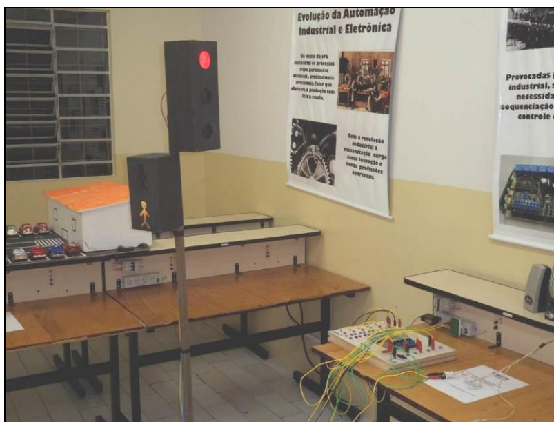
Figura 2: Protótipo do semáforo controlado por CLP
